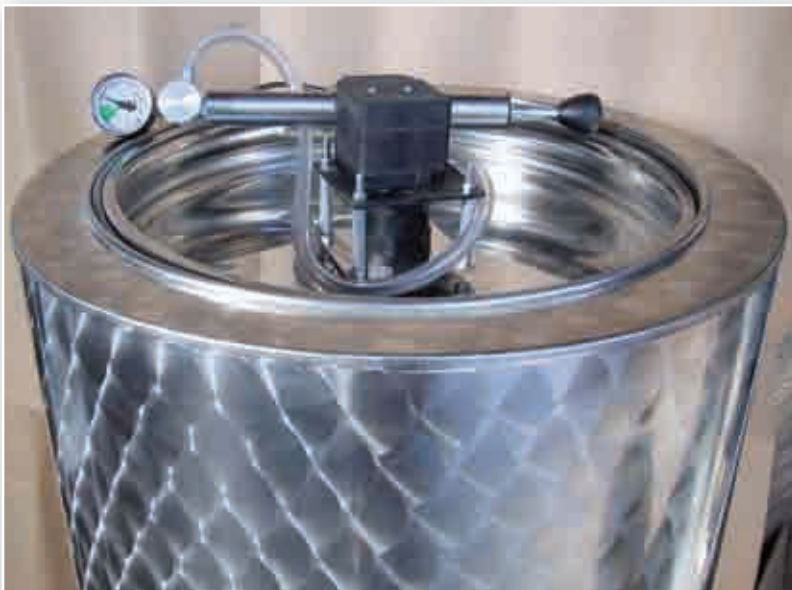
2 Serbatoio in acciaio inox per l'invecchiamento dell'aceto in ambiente riducente.
