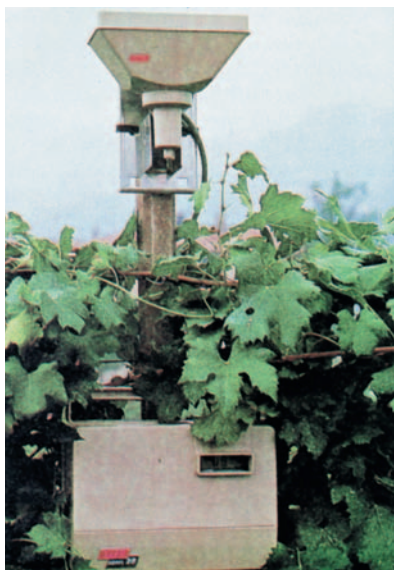
Fig. 198. Centralina Agrel per la lotta guidata nel vigneto.
